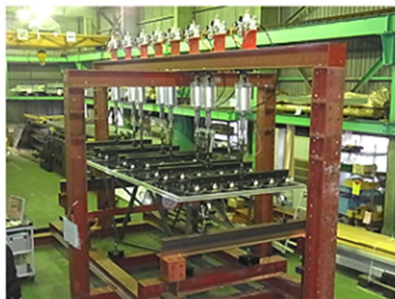
架台の耐風圧性能試験のイメージ
