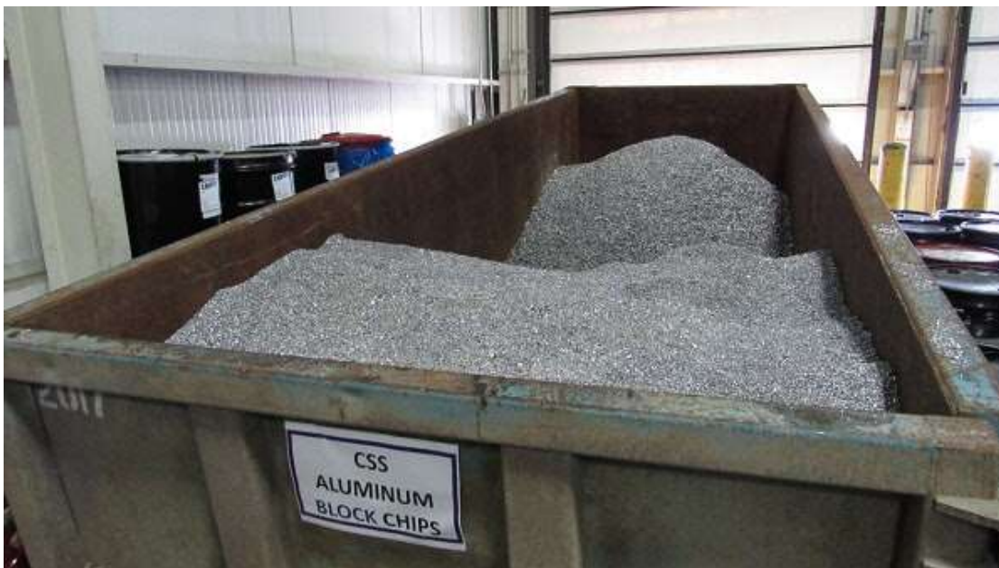
ミシガン州フリントにあるGMのエンジン工場ではメタルチップを回収してサプライヤーに提供、チップはそこで新しい素材にリサイクルされている
